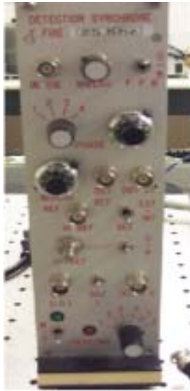
Figure 4.9: Boîtier de détection synchrone. Le boîtier de détection synchrone génère une modulation que l'on envoie sur le courant. Le signal d'absorption saturée est injecté en entre u boîtier, où il est démodulé et filtré. Le signal d'erreur obtenu peut être soit visualisé soit envoyé sur la cale piézo après passage par un intégrateur
